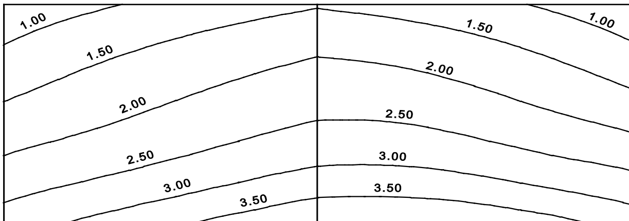
Bild 4.63 Isolinien der Setzungen s [cm] Berechnung mit Interaktion und mit Querkraftübertragung (Fall 3) Mit Einfluss der seitlichen Auflast
